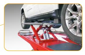
•« Lift-table » avec double vérin de levage pour assurer le parallélisme continu du levage.
