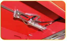
• Chemins de roulement oscillants avec verrouillage pneumatique depuis la centrale.
